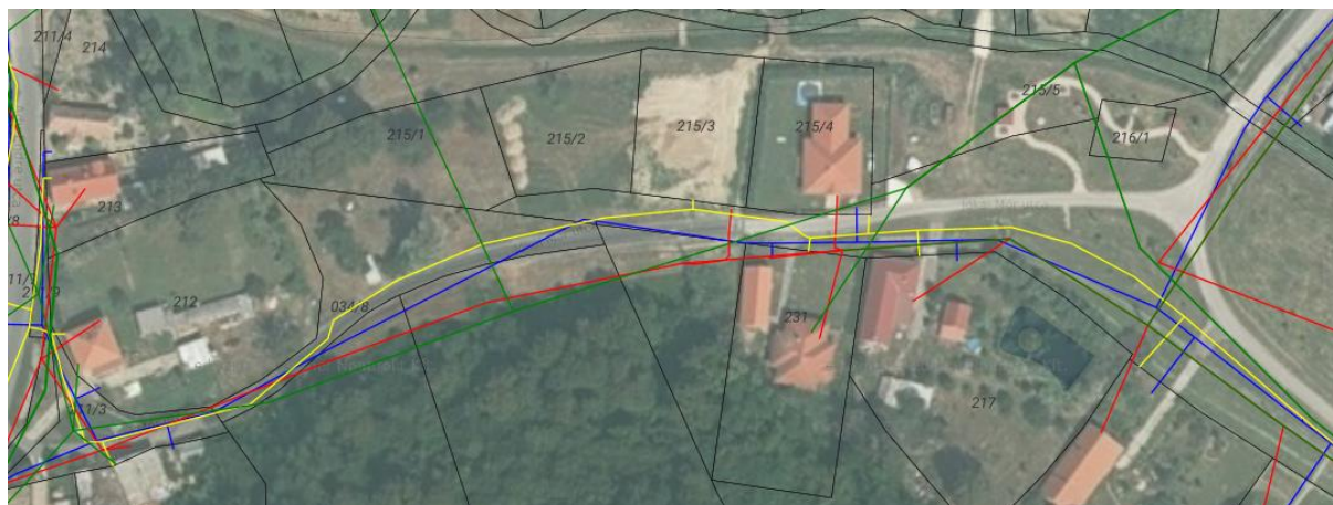
A módosítási terület közműtérkép részlete (piros villamos energia, kék vízellátás, sárga szénhidrogén, zöld távközlés)
