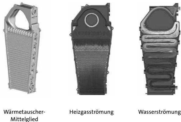
Abb. 5: Wärmetauscher-Glied
